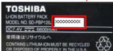
図5 バッテリーパック貼付ラベルの製造ロット番号 拡大図
