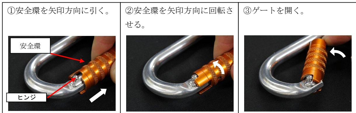
写真1. 事故事例で使用されていた自動ロック式のカラビナの構造（事故同型品）
